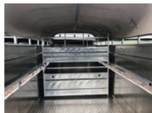
Vnitřní dělicí příčka s více závěsnými místy (kromě 2,5 m modelu)
