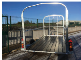
33mm odolná dřevěná podlaha s hliníkovou nášlapnou deskou pro plně utěsněný povrch.
