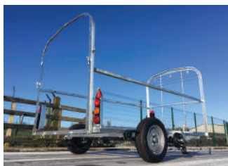
Šasí vyrobeno z kvalitní oceli s plně svařovaným rámem pro maximální pevnost a odolnost.
