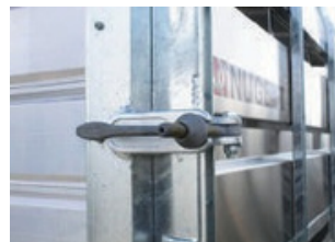
Robustní zavírání zadních dveří. Šroubové zavírání je jednoduché a účinné. Skvěle drží rampu.
