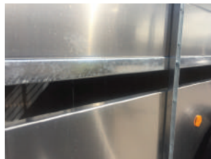
Jednotlivé sekce přepravníku pro vyšší pevnost a vyztužení boxu.
