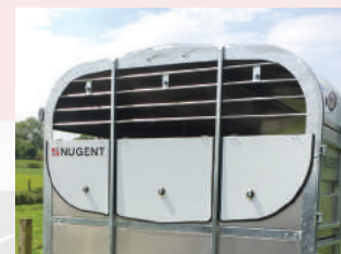
Jedinečná trojice sklopných předních panelů Nugent umožňuje uživatelům regulovat proudění vzduchu v přívěsu. Tím se snižuje odpor vzduchu a přívěs lépe táhne, zároveň se výrazně snižuje spotřeba paliva.
