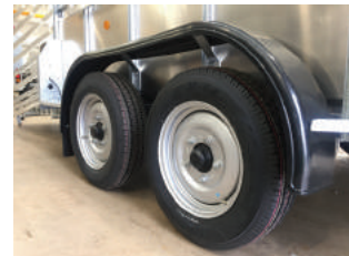
Díky větší ploše kol se přepravník lépe táhne v terénu a poskytuje větší stabilitu na silnici. Menší valivý odpor přináší menší spotřebu paliva a snižuje záprah tažného vozidla.
