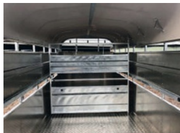
Další dělicí příčka + možnost doplnění držáku na příčku v čele přepravníku zvenku
