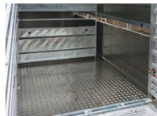
33mm dřevěná podlaha s jednoduchou, plně utěsněnou 3mm hliníkovou nášlapnou deskou
